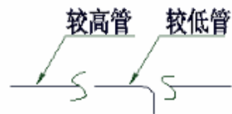
(b) 重叠管道
