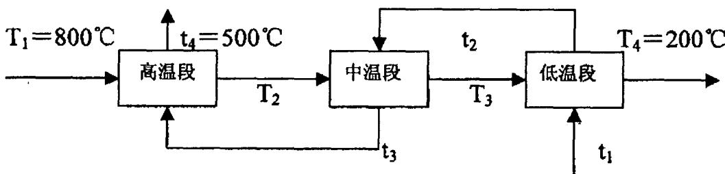
在此换热过程中高温介质是由煤燃烧后通过引风机直接进入热风炉的烟道气,而低温介质是经过净化处理的空气。
